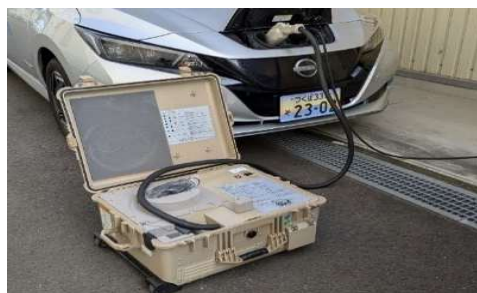
電気自動車外部給電器 (災害時の電力として活用)
