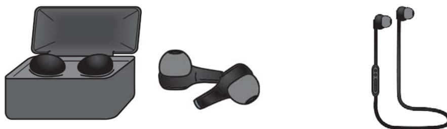
図1 完全ワイヤレスイヤホン（左）、左右一体型ワイヤレスイヤホン（右）
