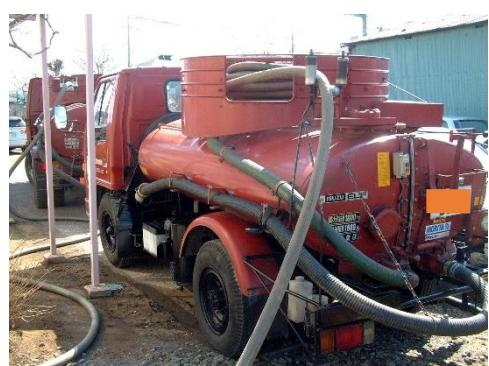
図 4.3.1 バキューム車による収集作業
