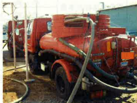
図 4.3.1 バキューム車による収集作業
